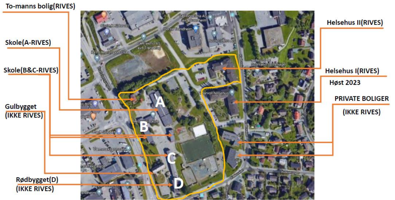
Figur 2: Omfang av riving
