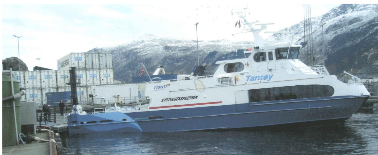
MS Tansøy med vekt fra 50 tonns ferjekaibru i Måløy (dvs ca 25 tonn på kombibåtens resess)
