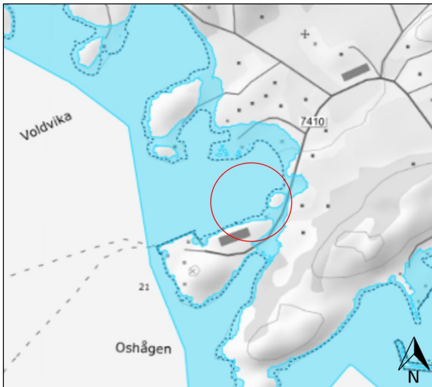
Figur 2. Kartutsnitt fra Se havnivå [4] som viser 200-års stormflo ved planlagt fergekai (rød sirkel).
