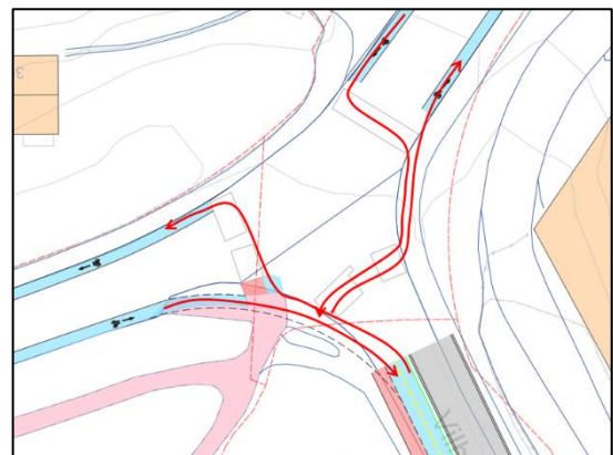
Figur 37: Prinsipiell kobling mot eksisterende sykkeltilbud ved kryss med Hagerups vei
