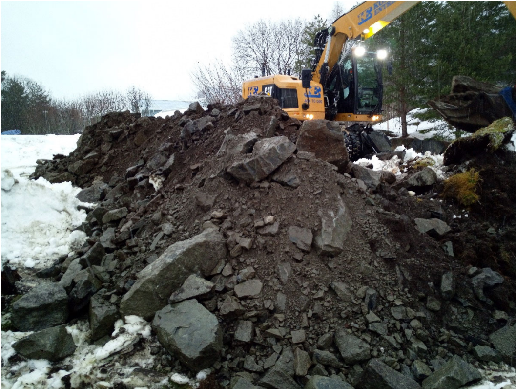
Bilde B9. Prøvegrop PG3. Løsmasser av mer spengstein blandet med jord. Mindre forekomst av torvjord i dette hull.
