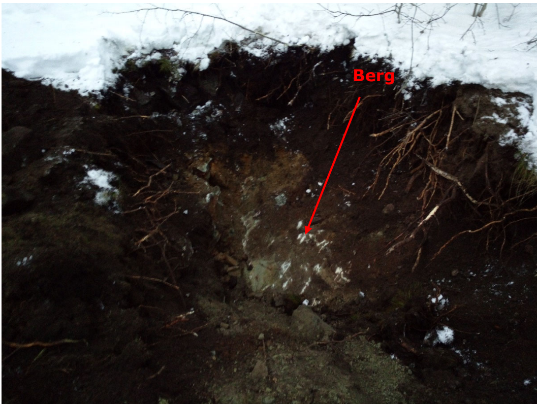
Bilde B2. Prøvegrop PG1. Berg påtruffet på ca. 1,5m.
