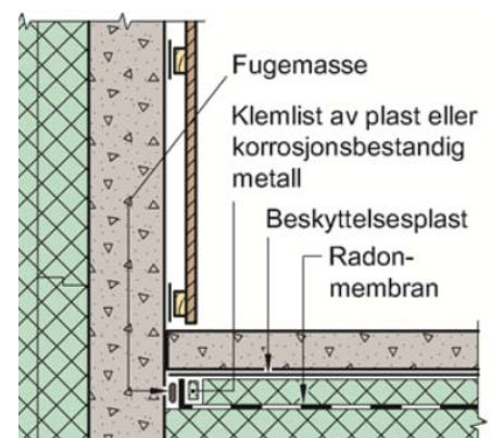
Figur 3.3 Gulv på grunn og kjellervegg
