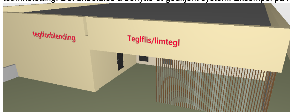
Figur 4.10 inngang fra takterrassen i 3.etg
