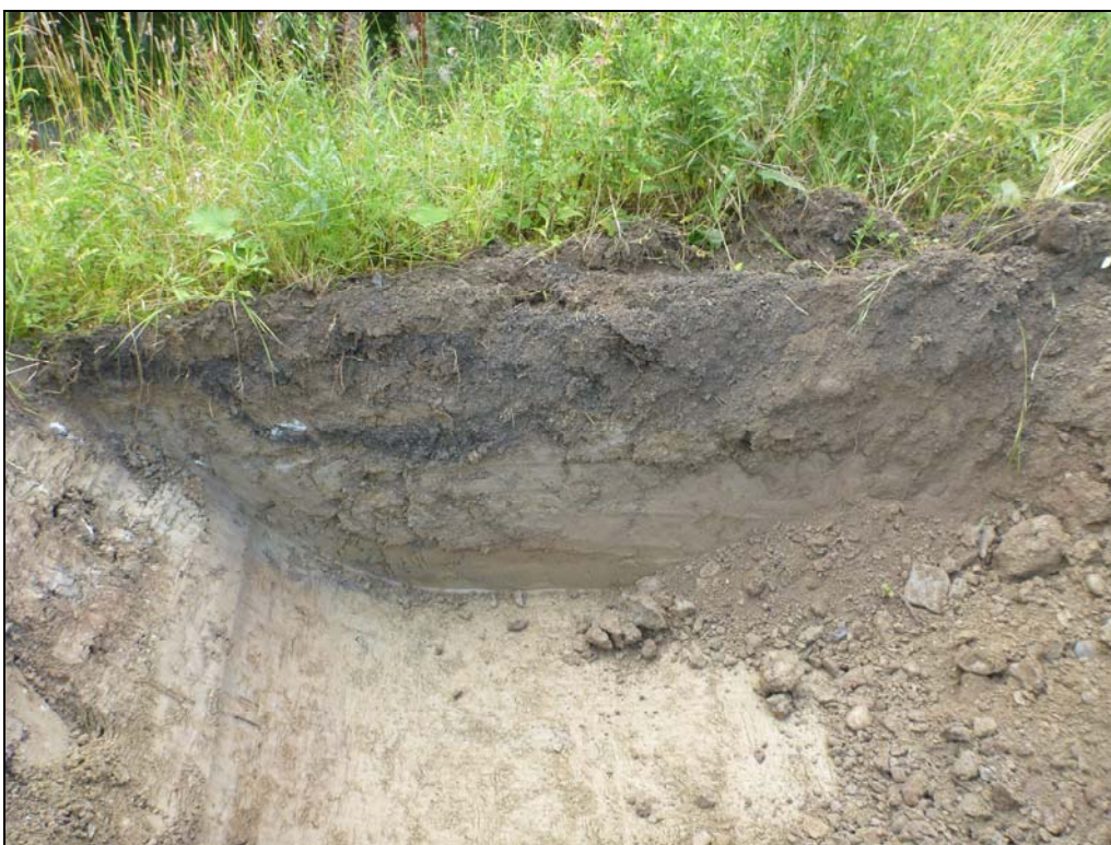
Figur 6 Sjakt i punkt 1: sandig jord over stedlig tørskorpeleire.
