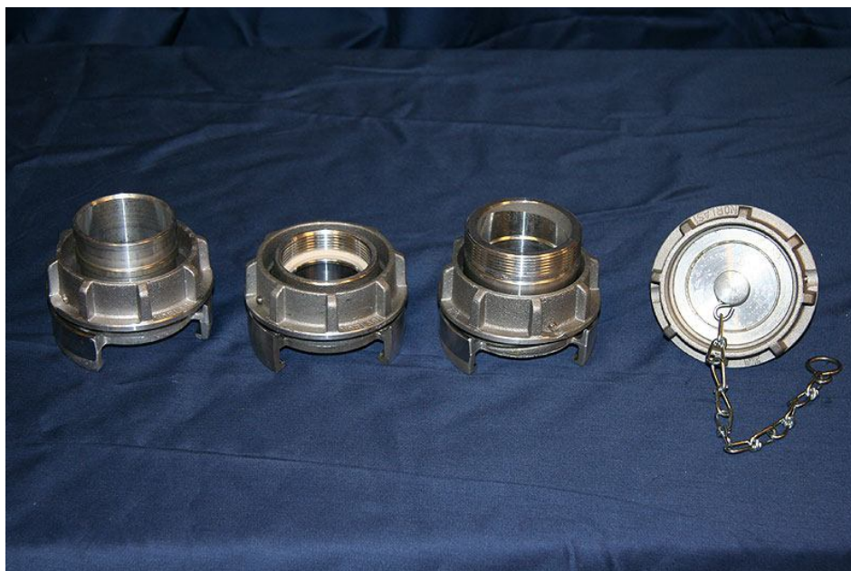
NOR Lås 1: Kuplinger HD, 65mm med ulike dimensjoner innvendige. /utvendige gjenger og slangehals. Blindlokk og overganger.
