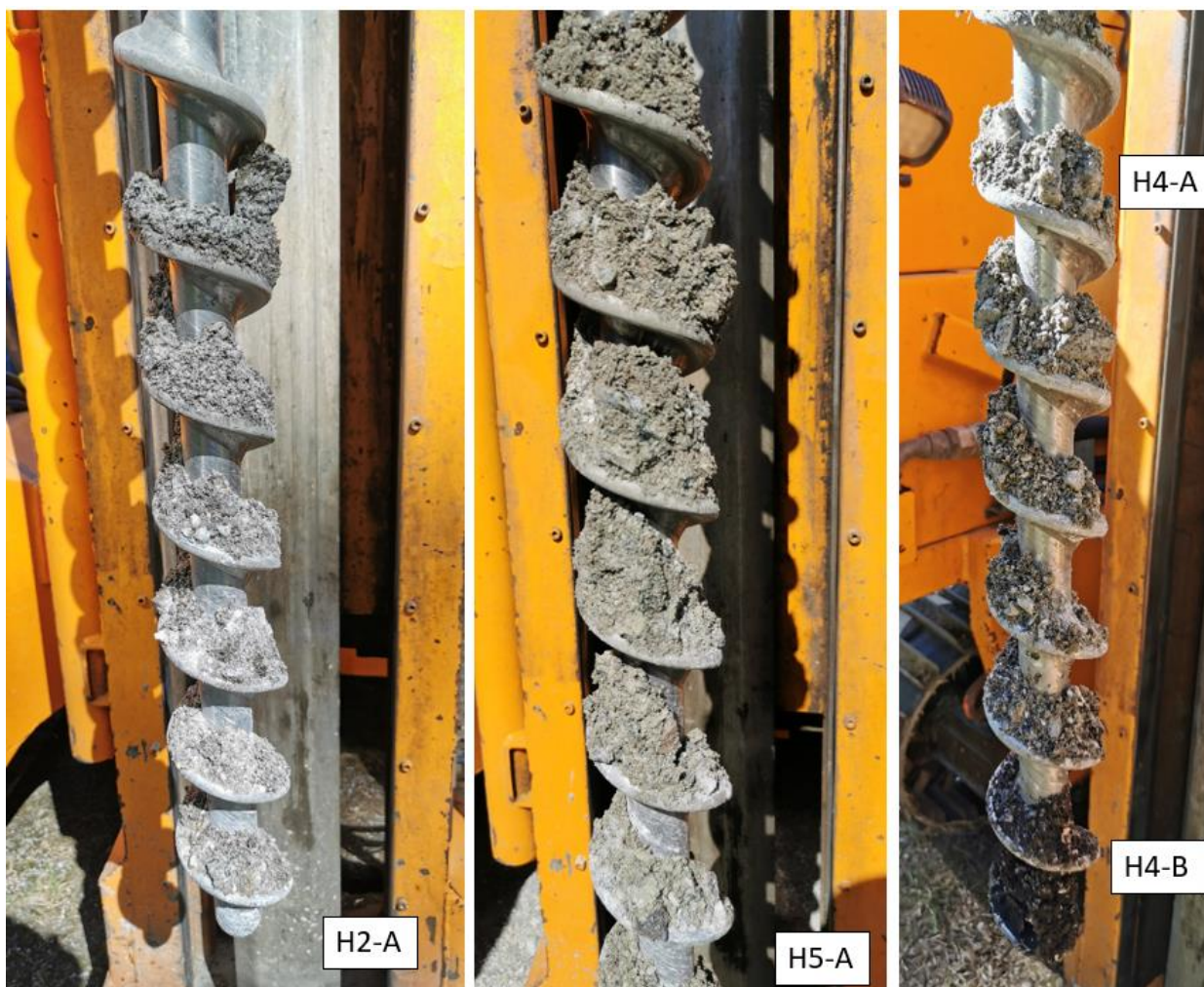
Figur 2. Foto fra felt viser skovlen med prøvetatte masser.
