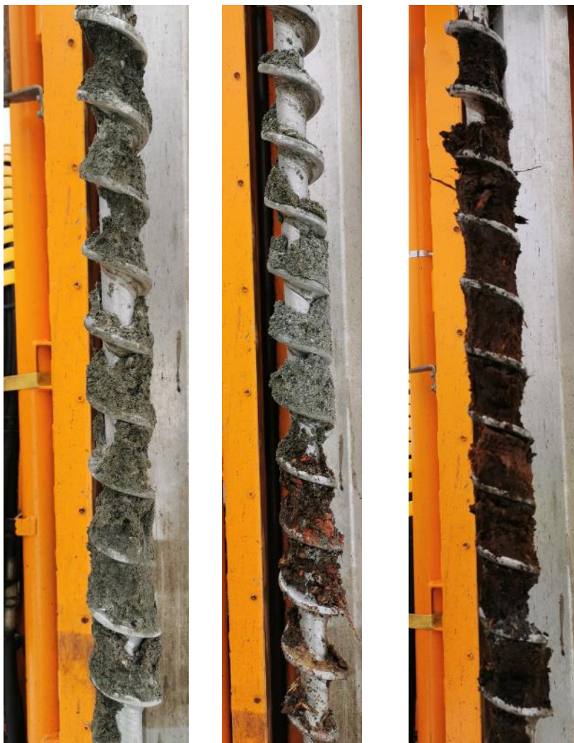
Figur 1 Foto fra felt viser skovlen med prøvetatte masser, fra venstre: A6 (0-1 m dybde), A8 (0-1 m dybde), A1 (1-2 m dybde).
