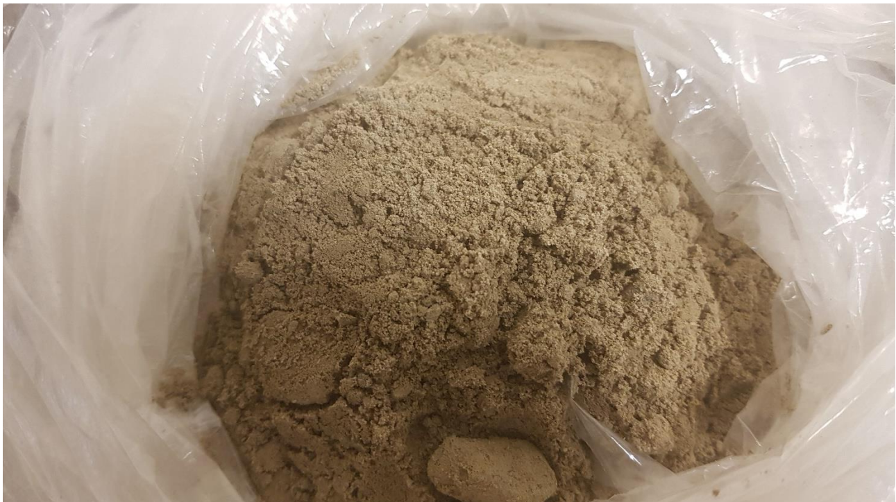
Figur 2 Posisjon F5, Sandig Grusig Siltig materiale fra 2,0 til 2,5 meter dybde.
