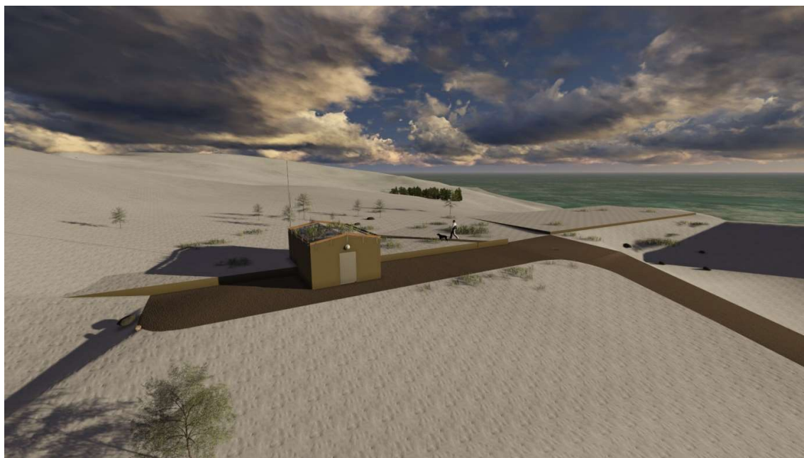
Bilde 6. Tursti retablert over eksisterende basseng uberørt av nytt plasstøpt basseng på siden.
