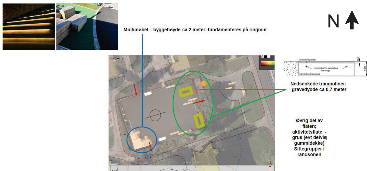
Figur 2 – Foreløpig plan for området. Multimøbel i sørvest og to nedsenkede trampoliner i øst. Kilde: Bergen kommune, Bymiljøetaten.
