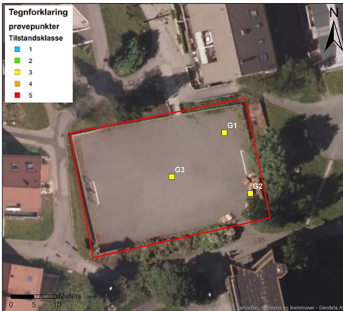
Figur 6 – Plassering av prøvepunkter og påvist forurensning på tomten. Prøvepunktene er markert med farge etter tabell 3 i henhold til påvist tilstandsklasse. Kilde: Kartverket.
