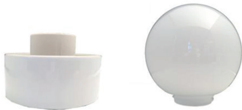
Glasskuppel, 18 cm diameter med hvit porselenssokkel. 2 stk på hvert bad i 1. etg, 1 stk på hvert bad i 2. etg, tilsammen. Generell belysning i tak på hvert soverom og i trapperom. Tilsammen 21 stk. På badene monteres disse på vegg over speil.
