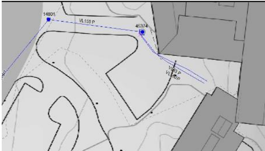
Figur 29: Vannkum nr. 45374 med 160 mm PE til sprinkel og 63 mm PE til forbruksvann
