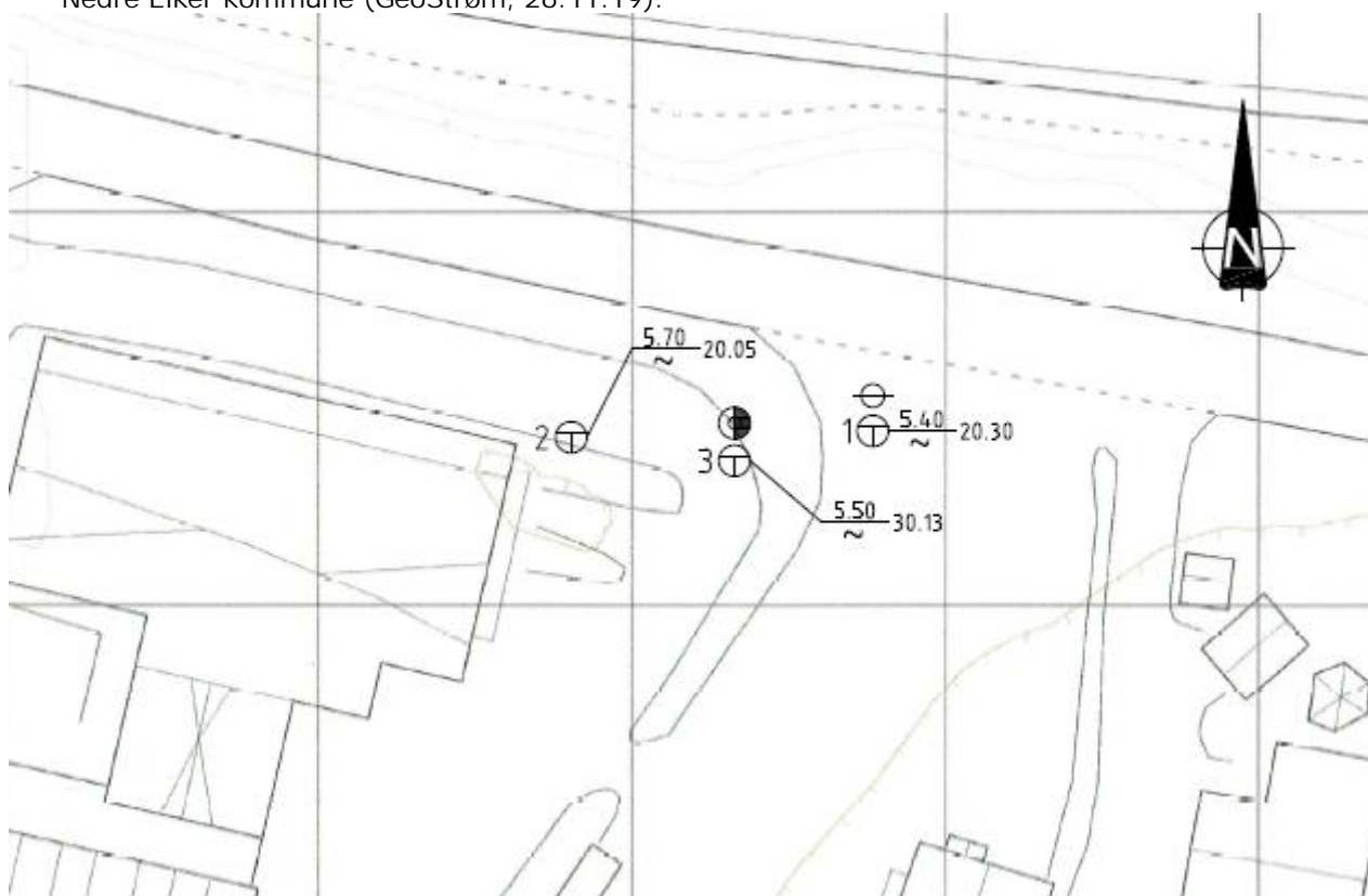
Figur 2: Situasjonsplan utførte grunnundersøkelser for Eian pumpestasjon.
