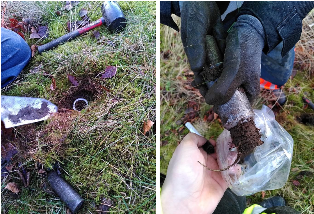
Bilde 1: Sylindere slått ned i toppjordsmasser (mose og gress er fjernet) vist til venstre, tømming av sylindere i prøvepose – vist til høyre.
