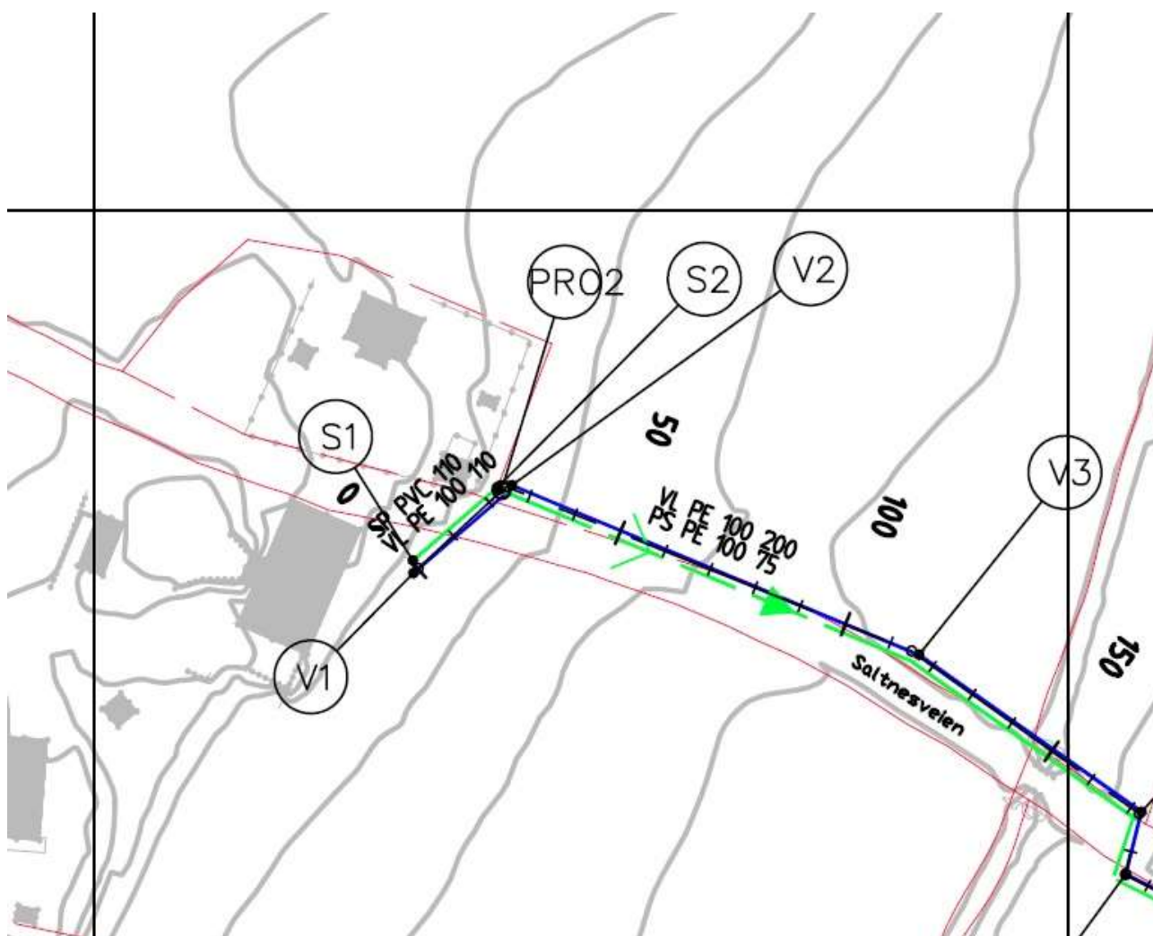
Figur 1 Plassering av pumpestasjon (Pro2)
