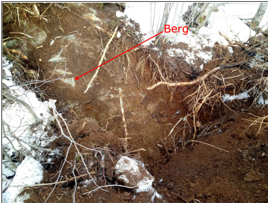
Bilde A-1. Prøvegrop PG1. Berg påtruffet på 0,5m. Løsmasser av silt/sand og jord.
