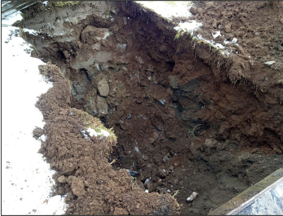
Bilde A-5. Prøvegrop PG5. Berg påtruffet på 2,1m. Løsmasser av sand/grus blandet med jord og sprengstein.
