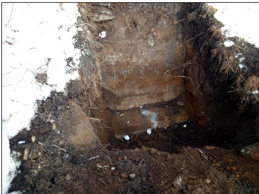
Bilde A-3. Prøvegrop PG3. Berg påtruffet på 1m. Løsmasser av sand/grus og jord.
