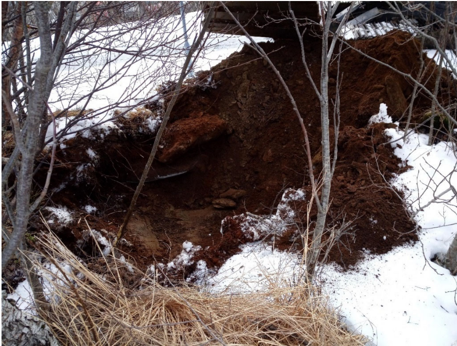
Bilde A-7. Prøvegrop PG6. Berg påtruffet ved 0,3m. Løsmasser av sand/grus.
