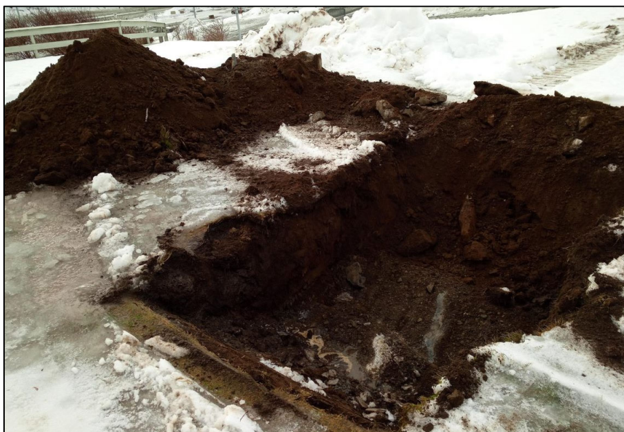
Bilde A-4. Prøvegrop PG4. Berg påtruffet på 0,5m. Løsmasser av sand/grus.
