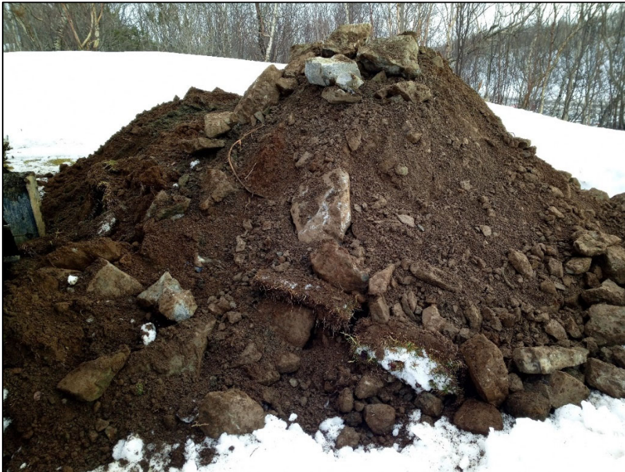
Bilde A-6. Prøvegrop PG5. Løsmasser av sand/grus blandet med jord og sprengstein.
