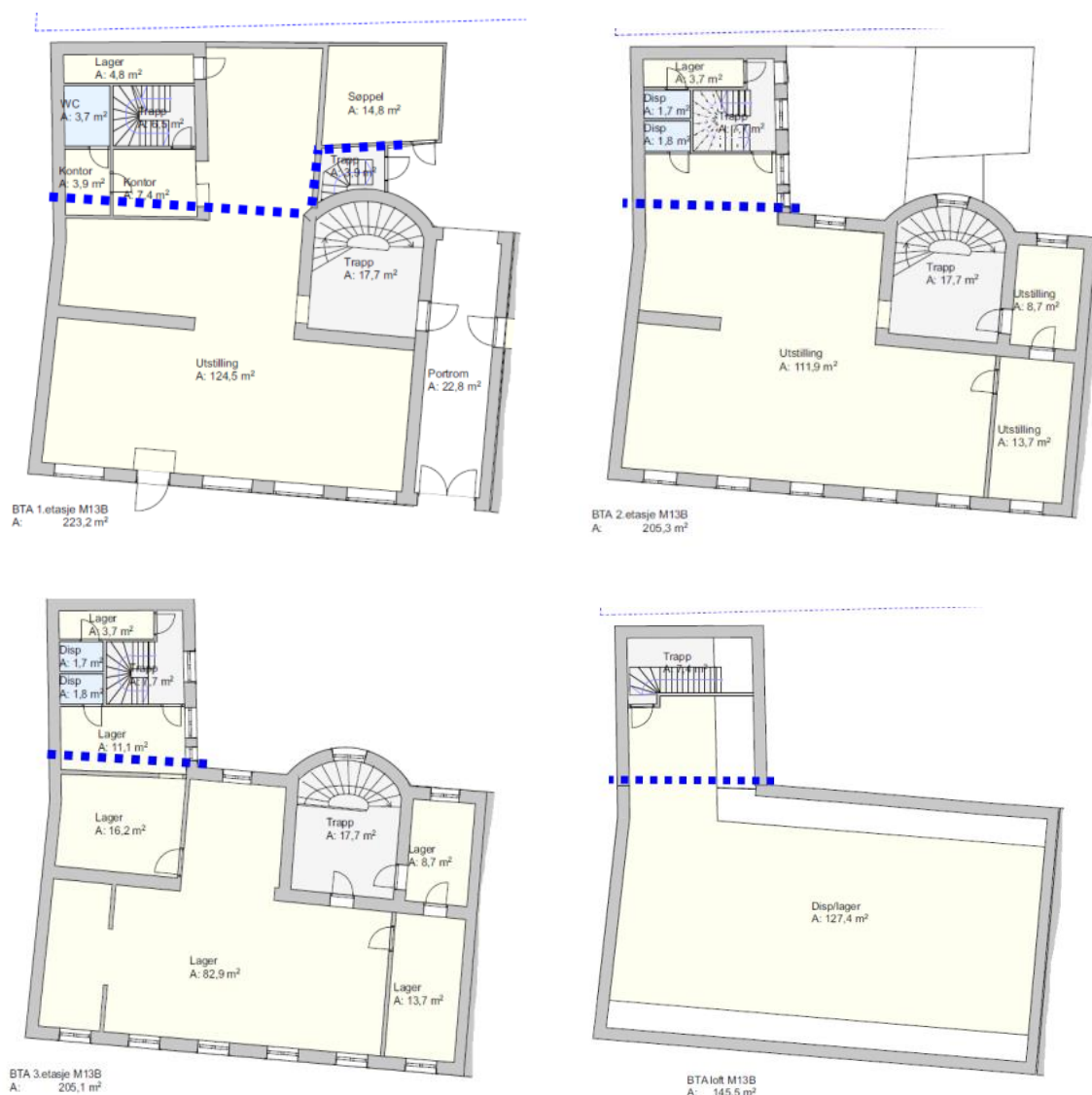
Figur 16. Rivesnitt i 1., 2. og 3. etasje samt loft.
