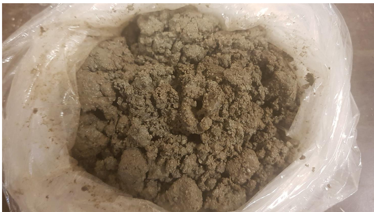
Figur 2 Posisjon H2, Sandig Grusig materiale fra 3,0 til 4,0 meter dybde.
