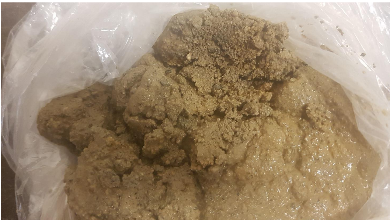
Figur 4 Posisjon H6, Siltig Sand fra 3,0 til 4,0 meter dybde.
