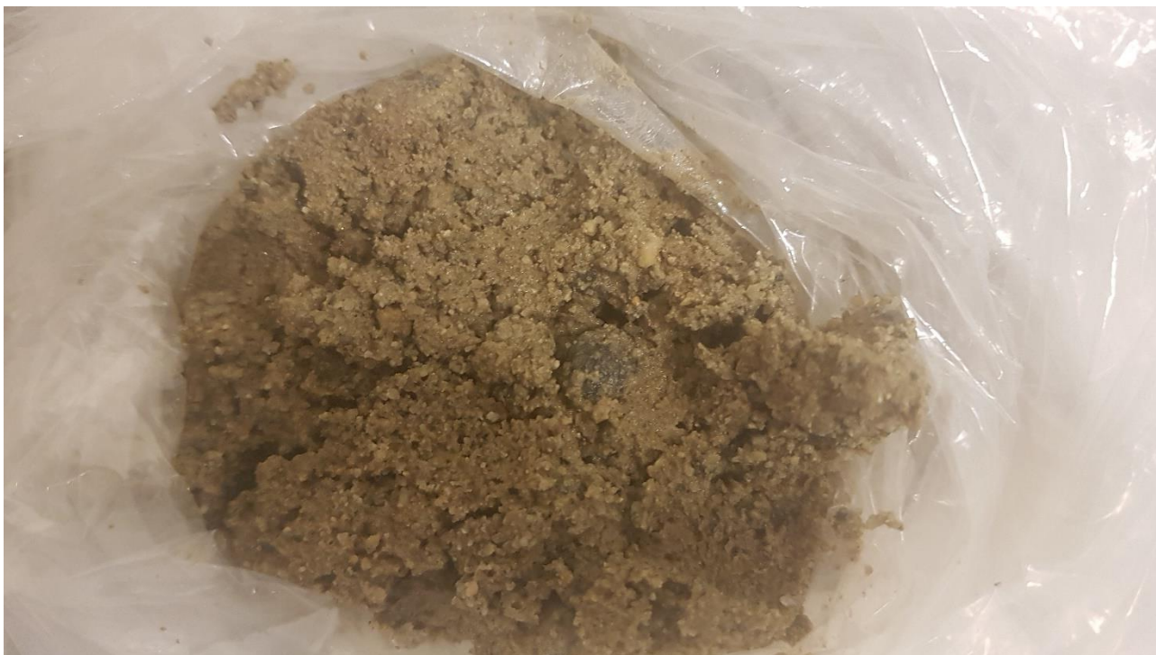
Figur 3 Posisjon H6, Grusig Sand fra 2,0 til 3,0 meter dybde.
