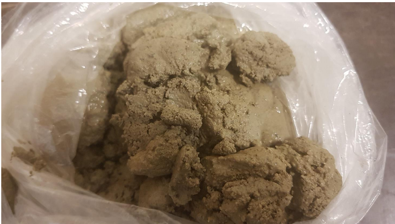
Figur 3 Posisjon F8, Siltig Sand fra 4,0 til 5,0 meter dybde.
