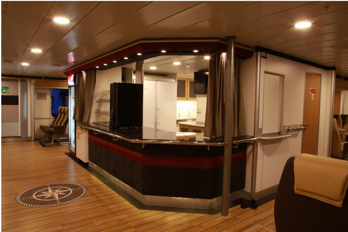
Figur 38 Kiosk plassert i publikumsarealet, med god kontrast til omgivelsene. Betjeningshøyde på skranke er 90mm. Det er viktig at fartøy med selvbetjent utsalg jar varer tilgjengelig fra ulike høyder (Foto: Norled AS)
