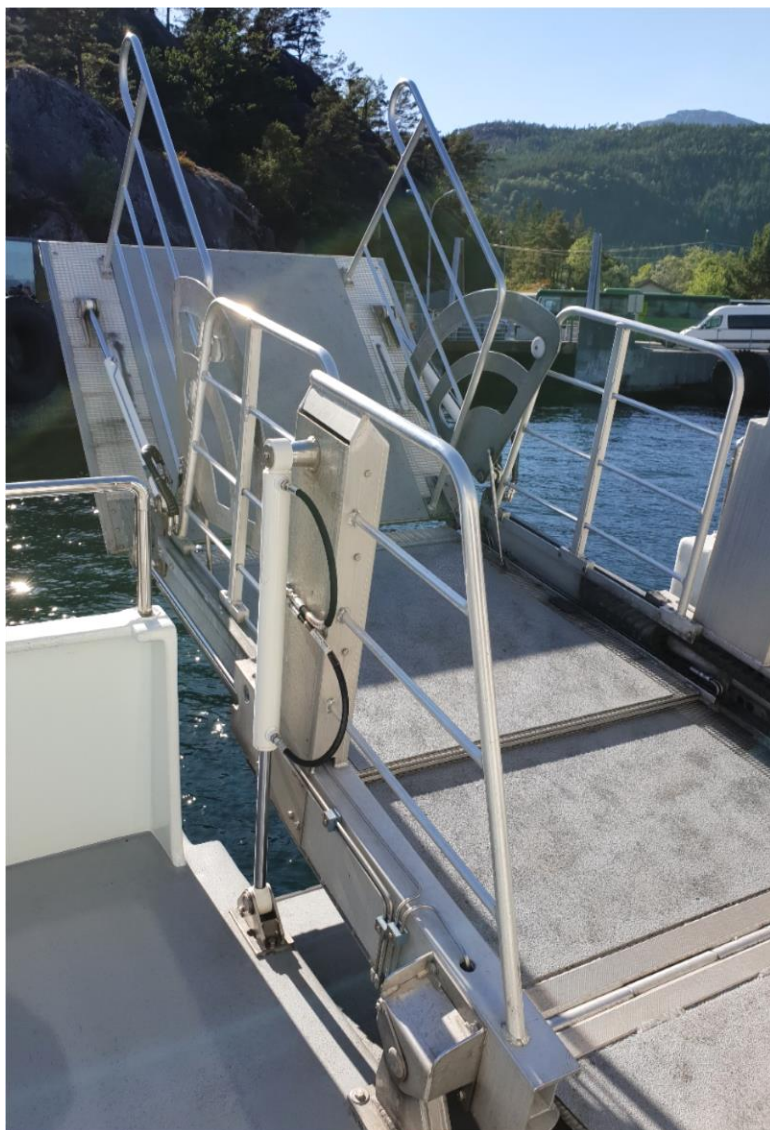
Figur 24 Flerleddet rampe for ombordstigning, hydraulisk mekanisme (Foto: Svein Ystanes, Kolumbus)
