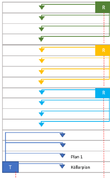
Figur 5: Passivt antensystem i en byggnad. Antennsystemet matas från ett teknikutrymme och flera radiatorum. Teknikutrymmet (T) och Radioutrymmena (R) förbinds med fastighetsfiber.
