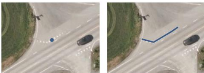
Figur 10. Viser to bilder med eksempel på registrering av vegoppmerking. Punkt (påkrevd), til venstre, og et eksempel med registrert geometritype linje (opsjonell), i høyre bilde.
