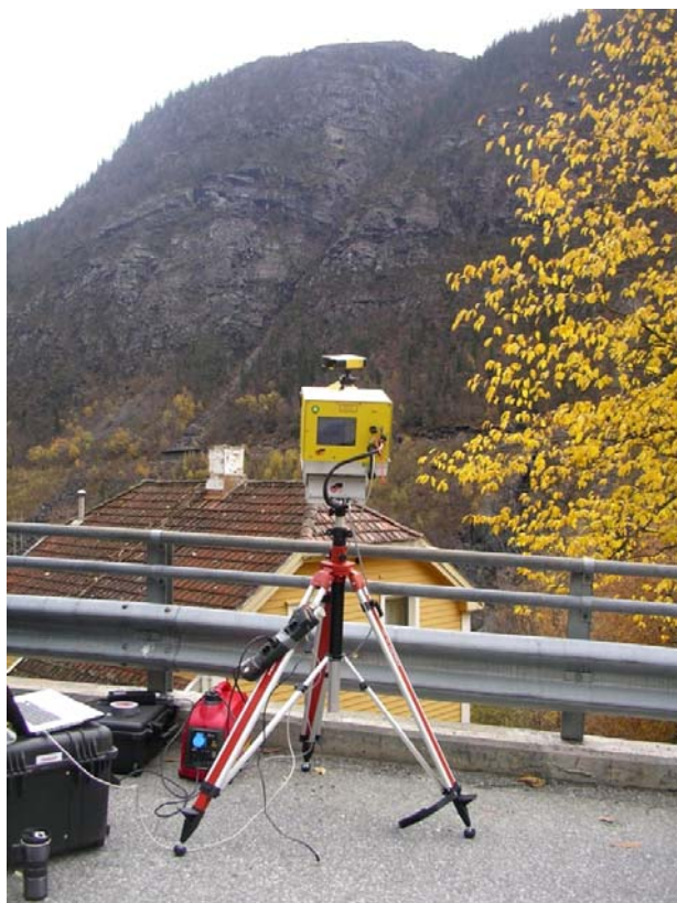
Figur 33: Oppstilling av Optech ILRIS-3D laser skanner på Våer. På toppen av laser-skanneren er det festet en differensiel GPS for stedfesting av de innsamlede dataene.
