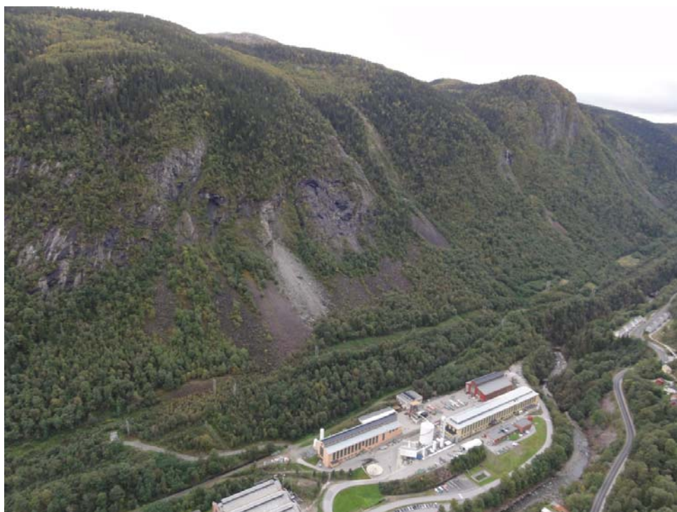
Figur 13: Oversiktsfoto over østlig del av strekningen (den østligste første kilometeren av veien er ikke med på bildet). Flere steile fjellpartier er synlige og skred utløses herfra med jevne mellomrom. Avstanden til veien gjør at strekningen likevel kan betraktes som relativt trygg.
