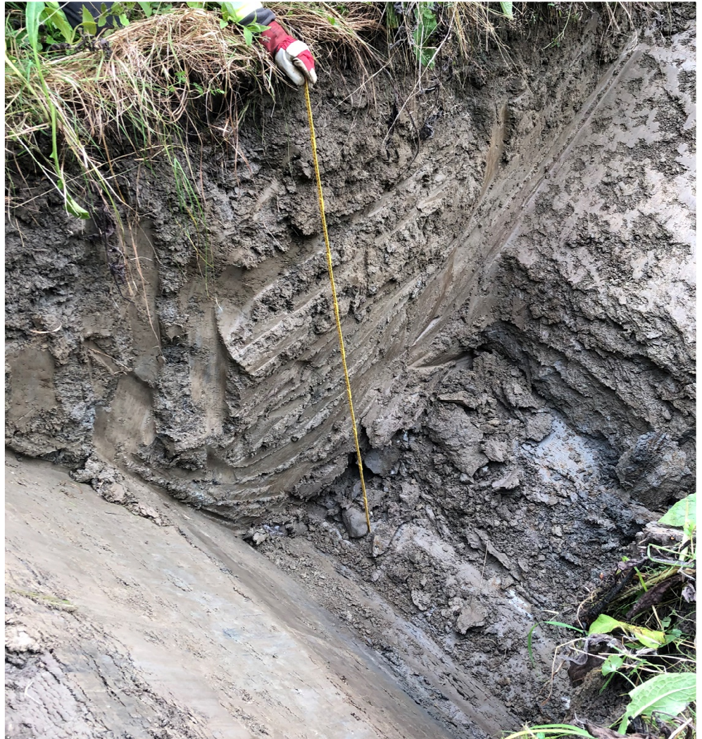
Figur 6: Fjell 2,0 m under terreng ved posisjon 1.
