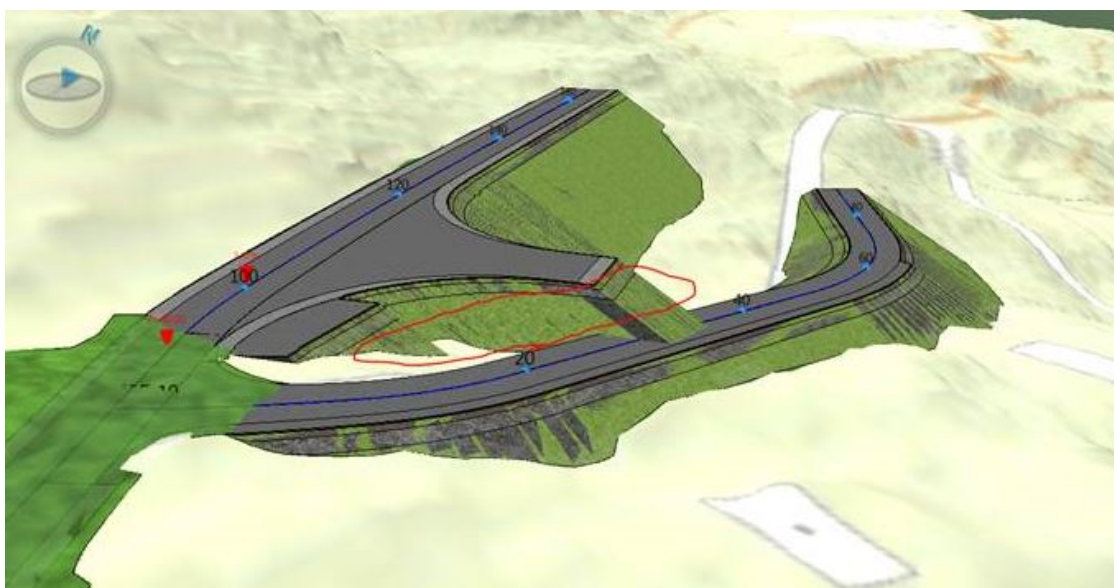
Figur 1 Utsnitt fra BIM-modell som viser beliggenheten av den planlagte støttemuren (oversendt av Vianova 10.05.2019)
