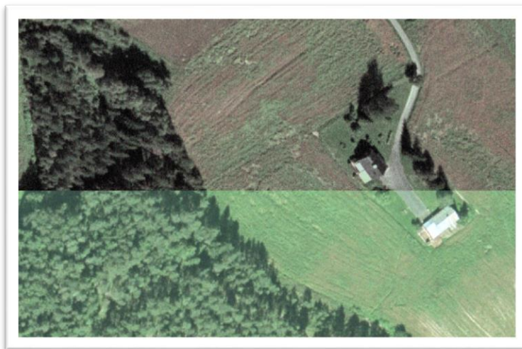
Figur B.1: Eksempel på varierende visuell ortofotokvalitet. Ortofotoet er laget fra flybilder med bildemålestokk 1:15 000 og ortofotooppløsning 20 cm. Det samme området er fotografert med mindre enn en måneds mellomrom. Det vurderes slik at den øverste delen av bildet viser eksempel på et ortofoto som ikke er klart og skarpt, mens den nederste delen viser hvilken visuell kvalitet man bør kunne forvente. Legg merke til fargeforskjellen mellom de to delene, samt hvor mørke skygger det er i den øverste delen av ortofotoet.
