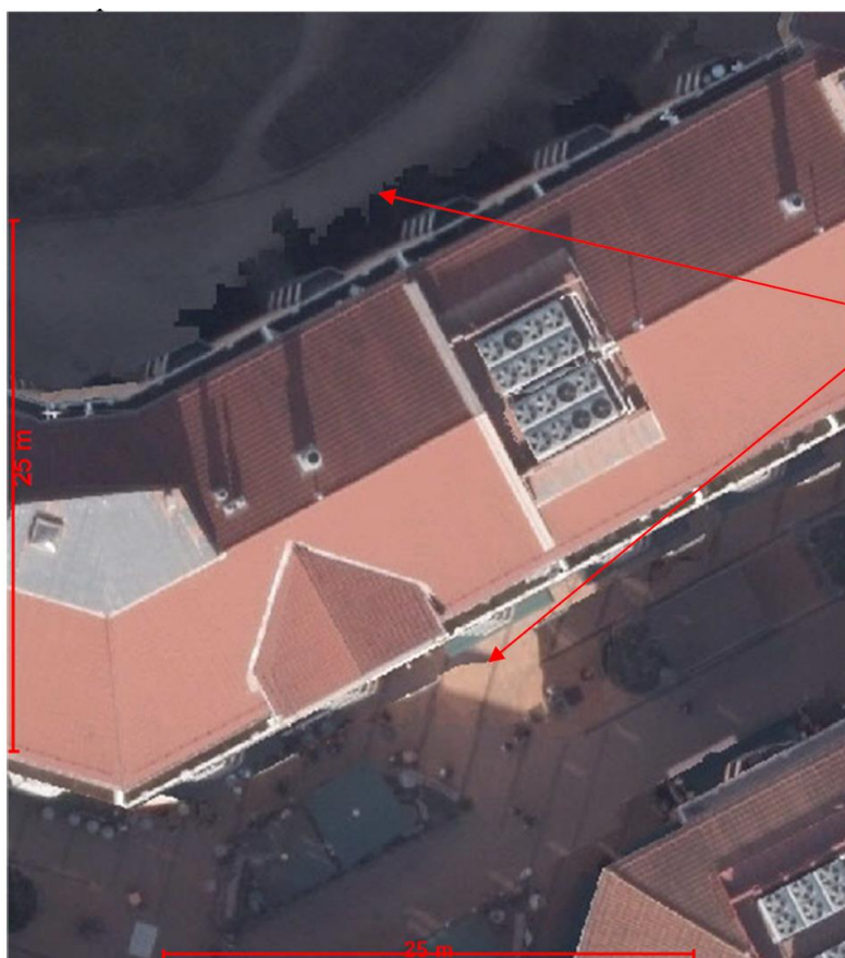
Figur B.11: Eksempelet viser tydelige sømlinjer som ikke er ønskelige. Forskjellen i radiometri langs sømlinjene i eksempelet skyldes i hovedsak at nabobildene har veldig ulike lys/skygge forhold. Slike sømlinjer skal justeres slik at de blir mest mulig usynlige. Eksemplet er laget av Oslo Kommune.
