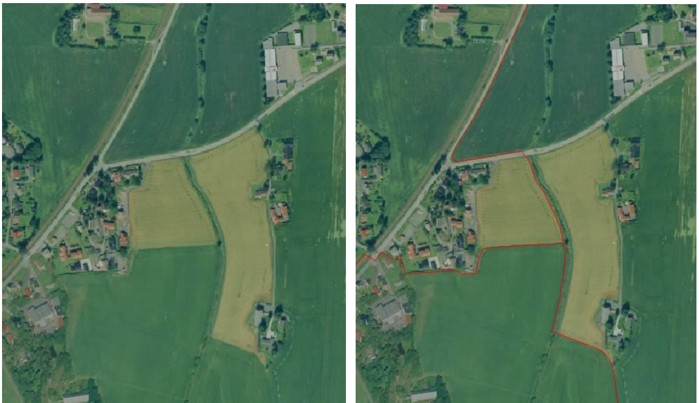
Figur B.4: Til venstre: Eksempel på meget god mosaikk av tre enkeltortofoto. Det er ikke mulig å se skjøtene mellom enkeltortofotoene. Til høyre: Samme bilde med sømlinjene påført (røde streker).
