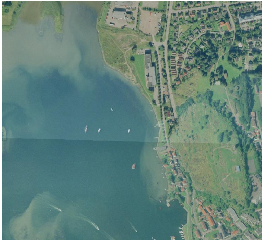
Figur B.5: Eksempel på ortofoto med dårlig kontrast- og fargeutjevning mellom enkeltortofotoene. I dette eksemplet er sømlinjen i tillegg rettlinjert. Dette i kombinasjon med den dårlige kontrast- og fargeutjevningen gjør at bildeskjøten vises svært godt. Det forventes at bildeskjøten er mindre tydelige enn i dette eksemplet.
