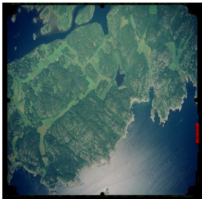
Figur B.1: Eksempel på varierende visuell ortofotokvalitet. Ortofotoet er laget fra flybilder med bildemålestokk 1:15 000 og ortofotooppløsning 20 cm. Det samme området er fotografert med mindre enn en måneds mellomrom. Det vurderes slik at den øverste delen av bildet viser eksempel på et ortofoto som ikke er klart og skarpt, mens den nederste delen viser hvilken visuell kvalitet man bør kunne forvente. Legg merke til fargeforskjellen mellom de to delene, samt hvor mørke skygger det er i den øverste delen av ortofotoet.
