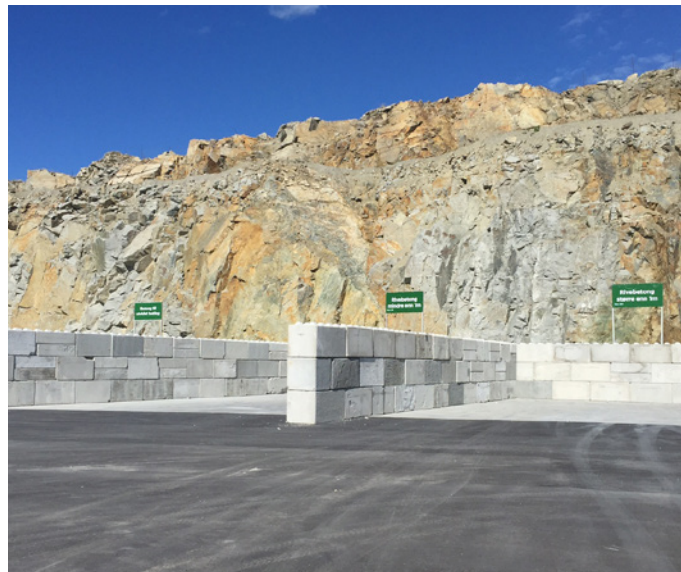
Mellomlager for betong på fast dekke. Fraksjonene er tydelig merket og fysisk skilt. Foto: Velde AS
