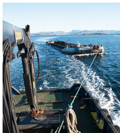
Lektertransport av masser fra Ryfast for tildekking av forurenset sjøbunn. Foto: Øyvind Ellingsen/Statens vegvesen.
