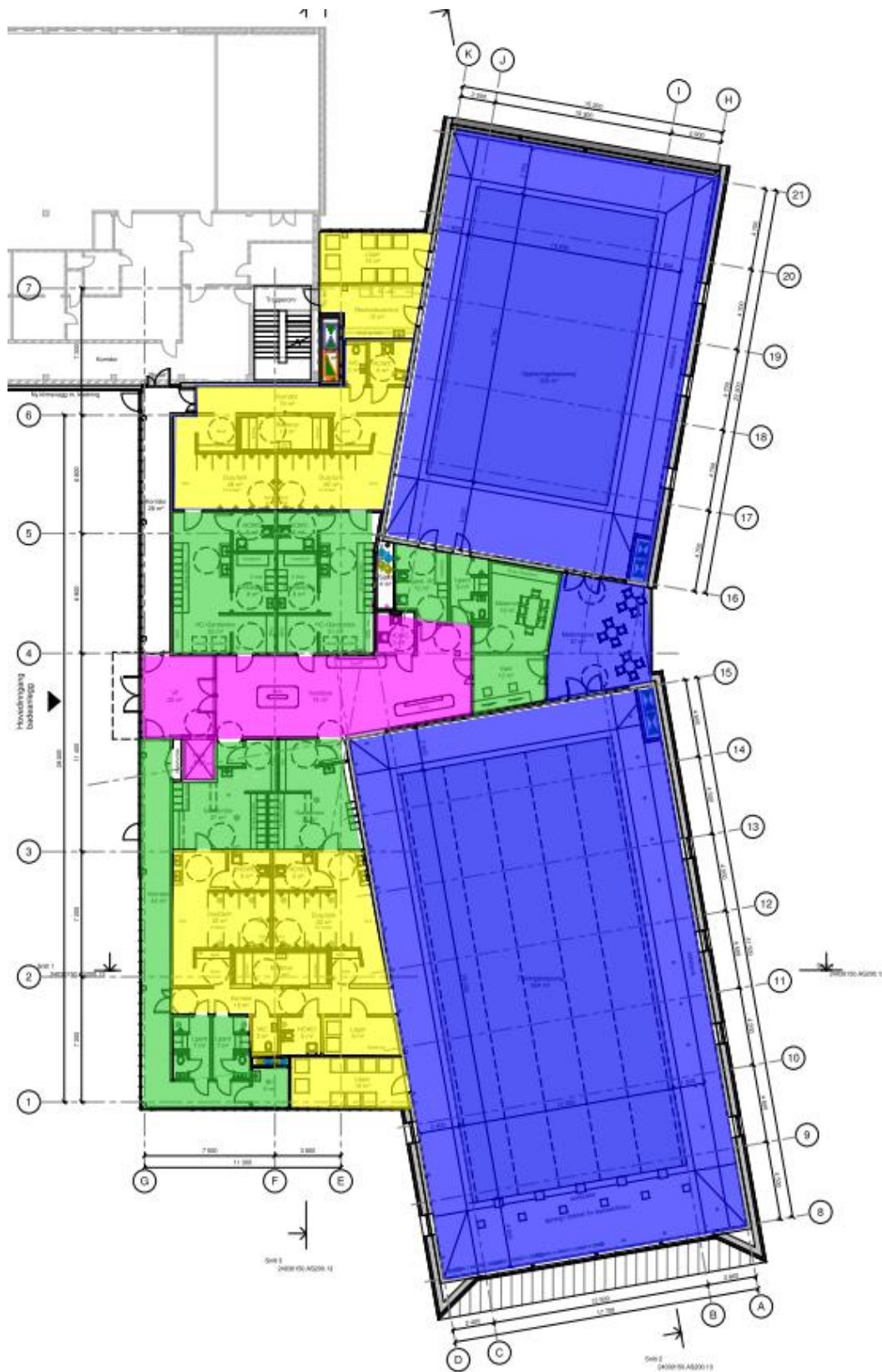
Figur 8. Korrosjonskart plan 2. C5=blå, C4=gul, C3=grønn, C2=rosa.
