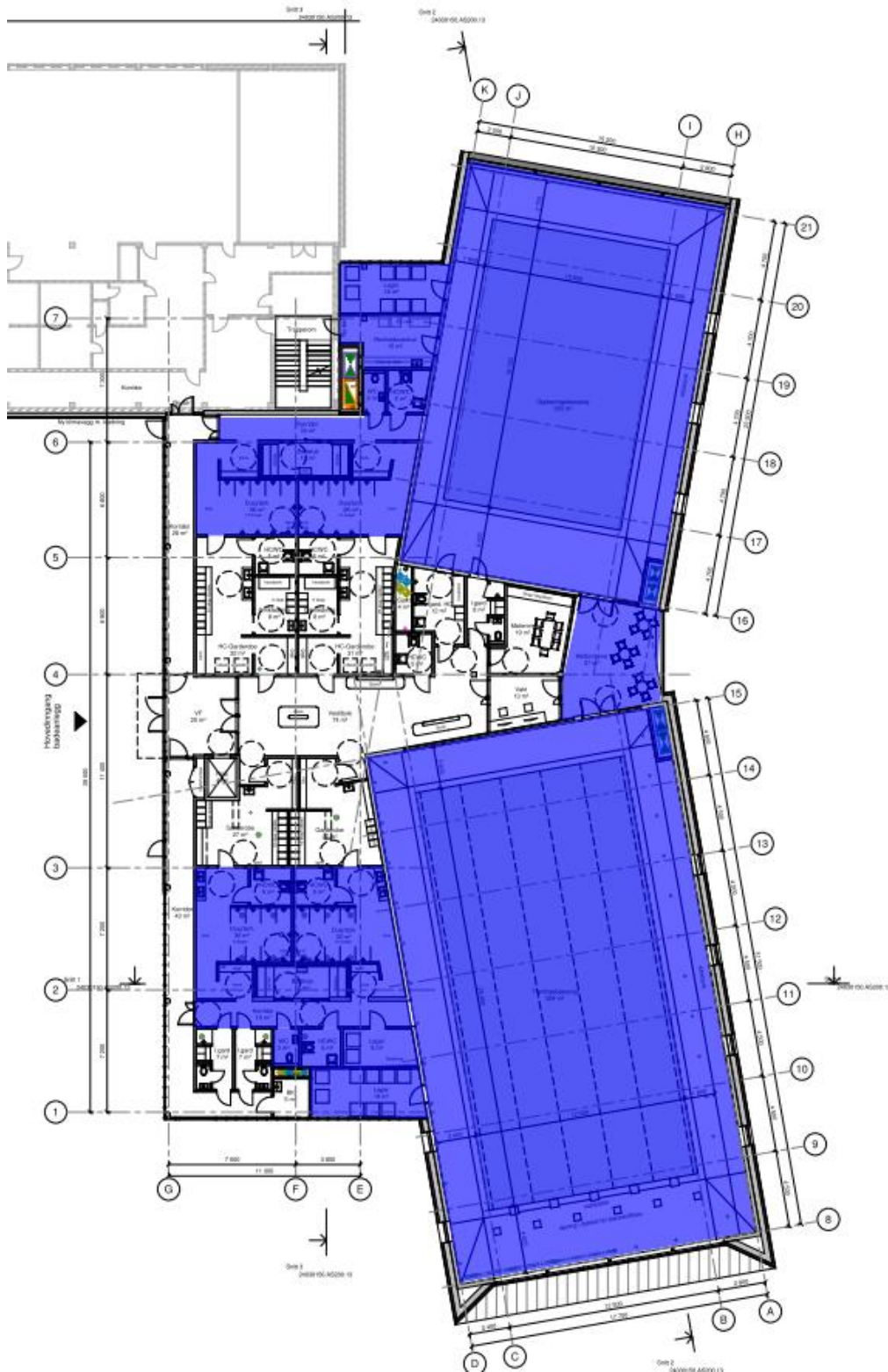
Figur 5. Inndeling mellom tørr og våt sone. Våt sone er vist med blått.
