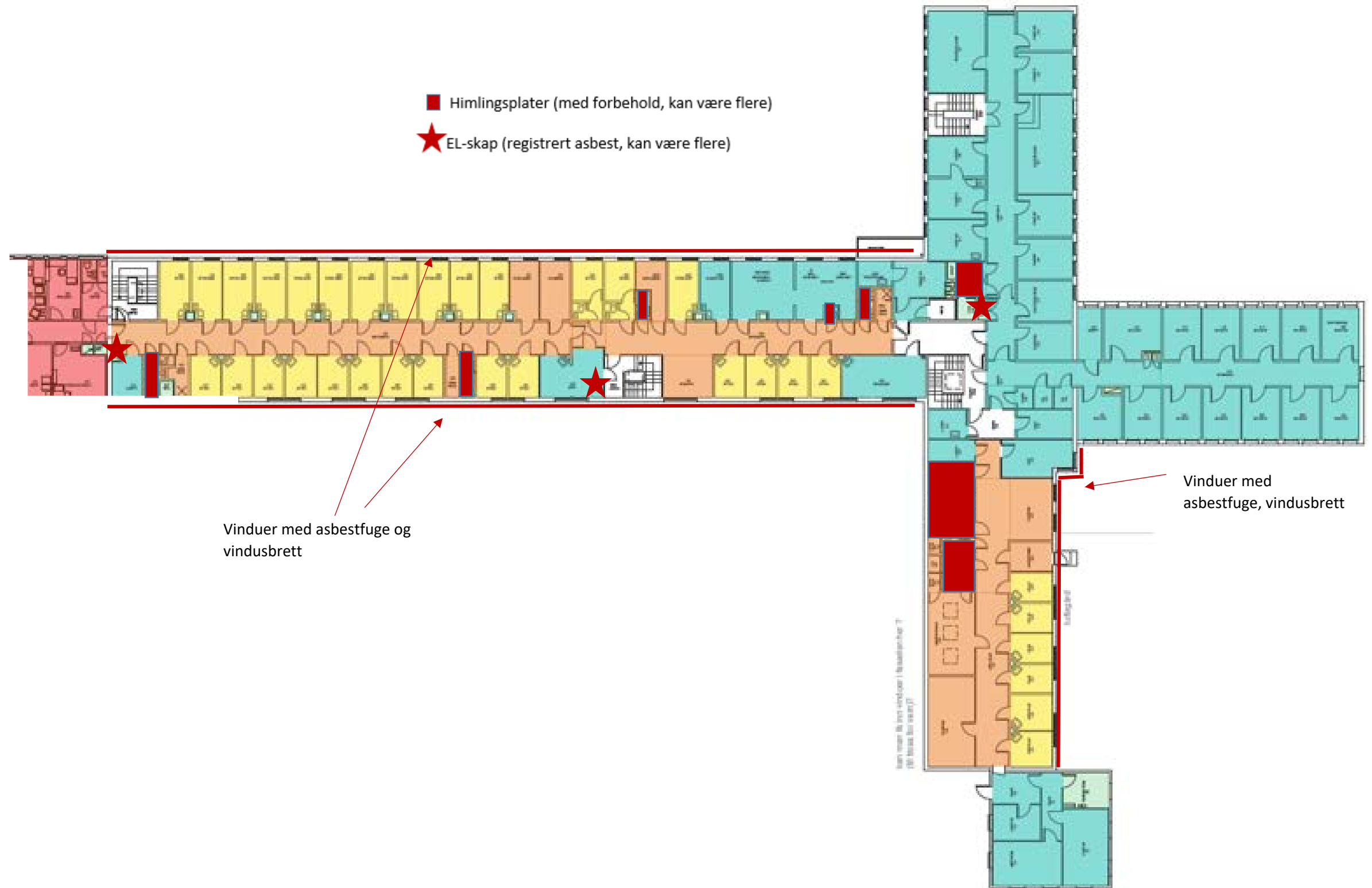
Figur 3 Plantegning av andre etasje med plassering av asbestholdige materialer.
