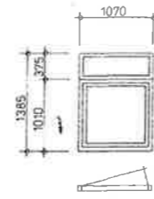
TYPE V5 (1070 x 1385) 52 STK. ÖVERSTE FELT FAST NEDERSTE FELT SIDEHENGSLER (L)
