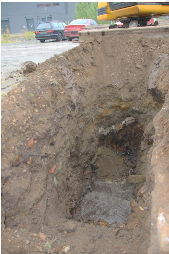
Prøvehull 1. 3,5 m dyp: Det ble tatt to prøver; prøvepunkt 1 (bunn), prøve 2 (1 m dyp)
