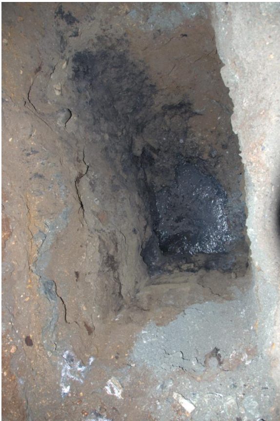
Prøvegrop 5. Prøve nr. 6 – 2,5 m dyp – Stygg lukt oljeaktig konsistens, prøve nr. 7 fra 1,5 m dyp.
