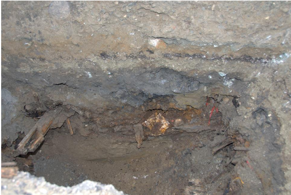
Prøvegrop 2. Dyp ca 2 meter. Avfall fra ca 0,7 m tilca 1,5 m. Prøve nr. 3 fra ca 1 m dyp.
