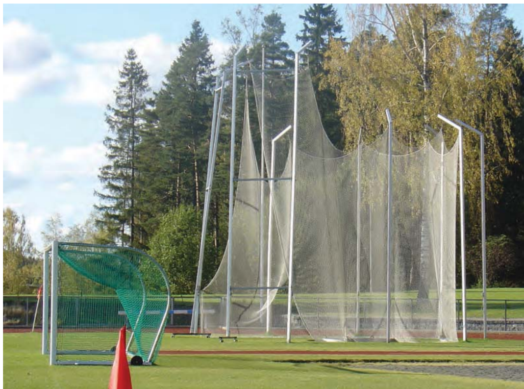
Figur 4.3.4: Dette er et kastbur egnet for sleggekast. Kastburet står i Askim idrettspark. Foto: Ole Petter Sandvig
