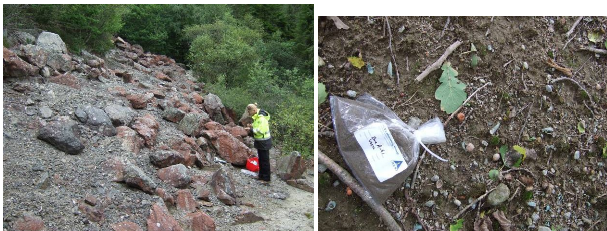
Bilde 5: Steinura bak kulefangervollen som er sterkt forurenset. Til høyre er bilde av baksiden av vollen som er relativt rene masser men med en del fragmenter i overflaten.
