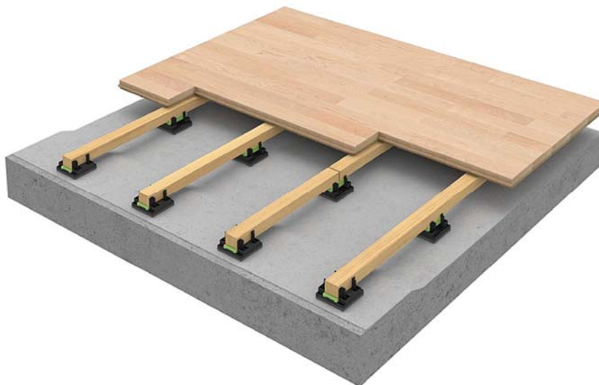
Figur 3 Prinsipp for oppbygging nytt idrettsgulv
