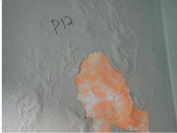
Figur 3.6.5 Grønn maling i garderobe lavforurenset med metaller. Prøven er feilmerket og skulle vært merket P10.
