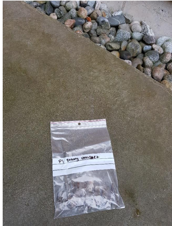
Figur 2. Betongen er prøvetatt for P1. den er ikke klassifisert som farlig avfall, men er likevel ikke egnet for ombruk grunnet høyt innhold av Cr 6+.
