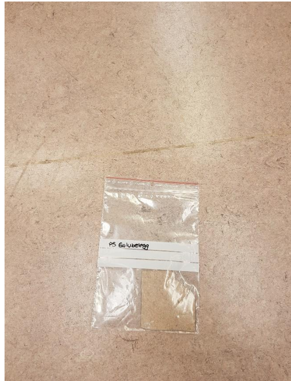
Figur 7. Linoleumsgulv prøvetatt i bygg B. Gulvbelegget er ikke klassifisert som farlig avfall.
