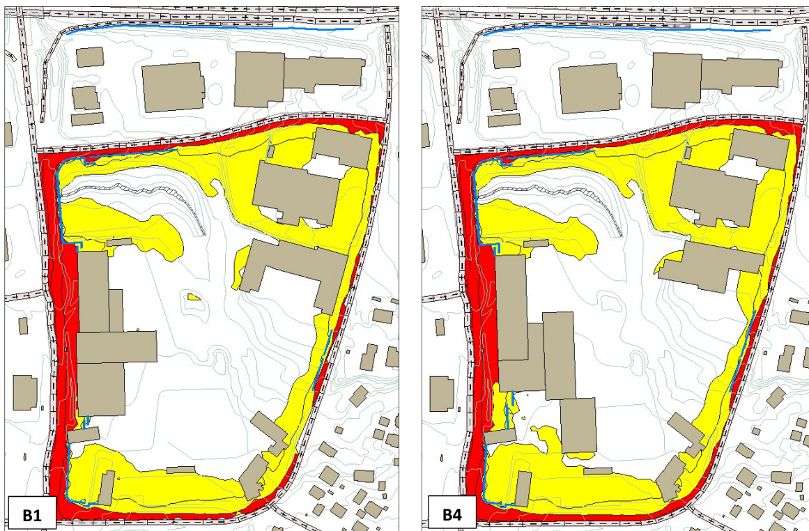
Figur 4: Dagekvivalent støynivå, L_d , 1,5 m over bakken med skjermers som foreslått i Figur 3 for hhv. alternativ B1 og B4. Gul sone 55 \leq L_d < 65 . Rød sone: L_d \geq 65 dB. Støysonekartene er også vist i hhv. vedlegg 4 og 5.
