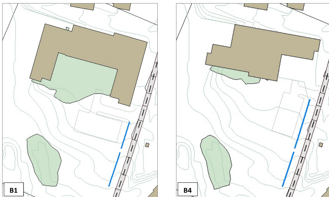
Figur 6: Døgnkvalent støynivå, L_{den} , 1,5 m over bakke med foreslåtte skjermer vist i Figur 3. Grønn sone angir hvor krav til uteplass på helseinstitusjoner er oppfylt, L_{den} \leq 50 dB.
