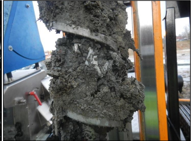
Figur 9 Bilde fra prøvepunkt VS28A. Avfall (plast, glass, isolasjon og piggråd) i masser av sand/leire.
