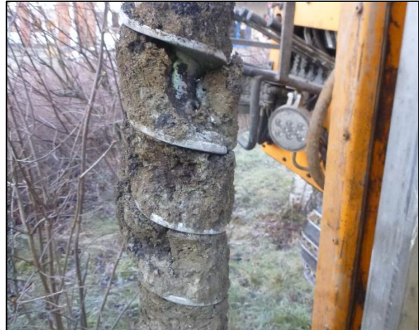
Figur 17 Bilde fra prøvepunkt SK19 0-1 meter. Jord/sand/grus/leire.
