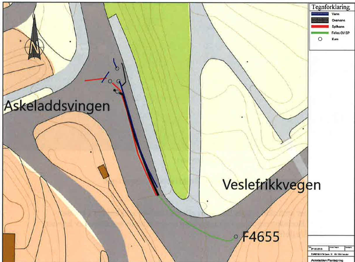
Etablerte ledninger som er avsluttet på nordsiden av krysset Drams-/Veslefrikkvegen
